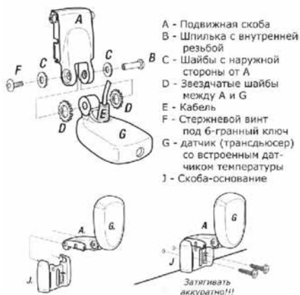
Рис. 4а. Сборка и крепление датчика Piranha 5x
