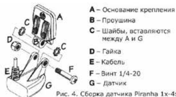
Рис. 4. Сборка датчика Piranha 1x-4x
