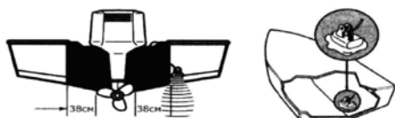
Рис. 1. Место крепления датчика на транце и внутри корпуса.
